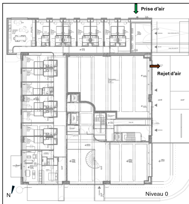
Figure 77 : Localisation de la prise d'air et du rejet d'air de la ventilation de l'unité HoReCa (Source : Van Reeth studiebureau ; Annotations : Advista)
